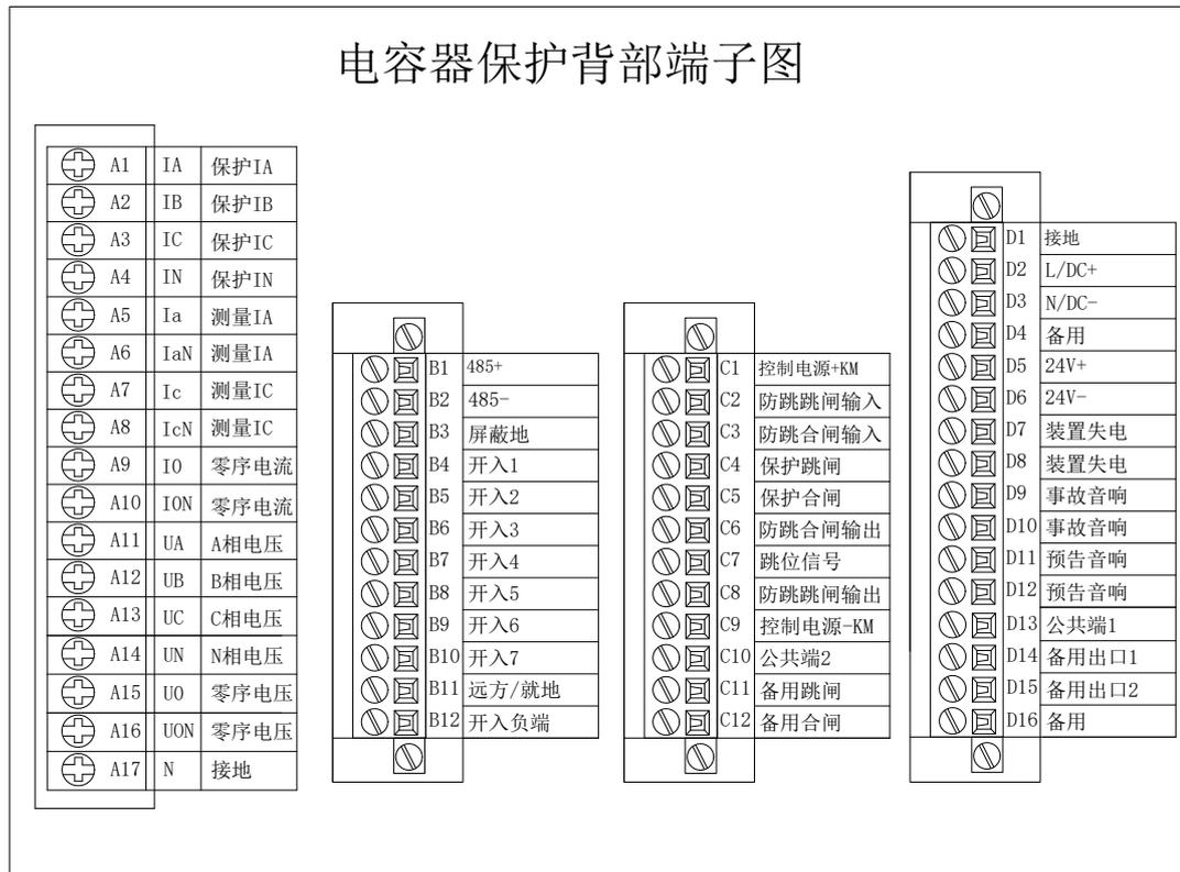
图 2-3 装置接线端子图
