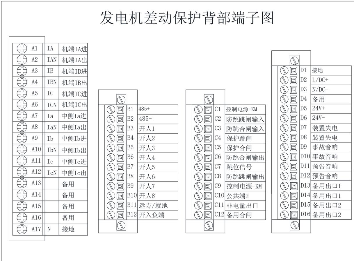
图 2-3 装置接线端子图
